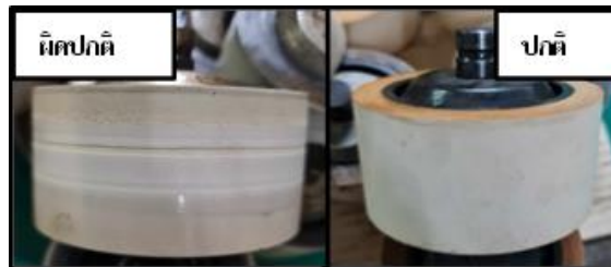
ภาพที่ 7 ลักษณะ Pinch Roller มีรอยและปกติ
