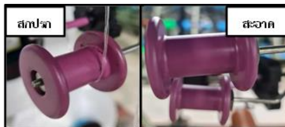
ภาพที่ 8 การทำความสะอาดตัว Guide ที่ห้อง Creel
