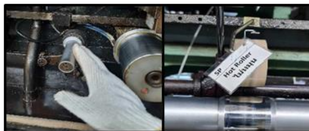
ภาพที่ 6 ภาพการตรวจเช็ค S-Roller หากไม่หมุนให้แขนป้าย
